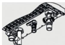
Juego de conexión del circuito de calefacción sin bomba de circulación
