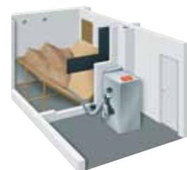
Espacio libre de montaje (profundidad) mín. de 100 mm entre el sistema de transporte con tornillo sin fin y la pared.
