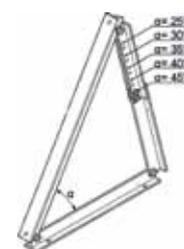
Juego de fijación para cubiertas planas con ángulo de ajuste variable
