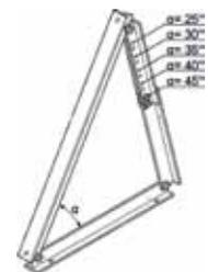
Juego de fijación para cubiertas planas con ángulo de ajuste variable
