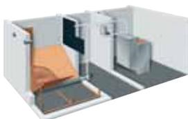
Espacio libre de montaje (profundidad) mín. de 100 mm entre el sistema de transporte con tornillo sin fin y la pared.
