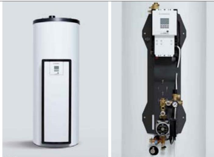
El sistema solar presurizado auroSTEP plus es un sistema de producción de ACS solar de carácter modular que permite al sistema ganar en flexibilidad. El depósito solar se puede combinar con un módulo solar que incluye todos los elementos necesarios: control, bomba, grupo de seguridad y tuberías. Como accesorio está disponible la resistencia eléctrica de apoyo.
