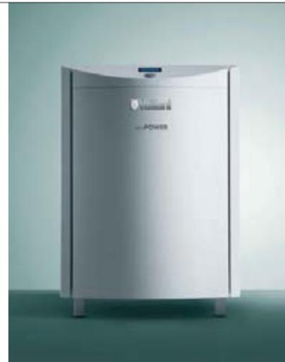
La cogeneración (CHP) es el proceso mediante el cual se genera electricidad y calor simultáneamente utilizando para ello un único generador. La máquina de microgeneración (mCHP) ecoPOWER se basa en la utilización de un motor de combustión a gas que acciona un generador para así producir energía eléctrica. El calor resultante del proceso de la combustión se utiliza para la calefacción y el ACS.
