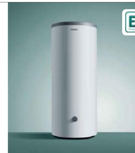
Los depósitos interacumuladores solares auroSTOR están disponibles en 3 tamaños (300, 400 y 500 L). Disponen de dos intercambiadores, al inferior se conectan los captadores solares y al superior la caldera. El aislamiento térmico de EPS es desmontable para así poder pasar por cualquier puerta estándar.
