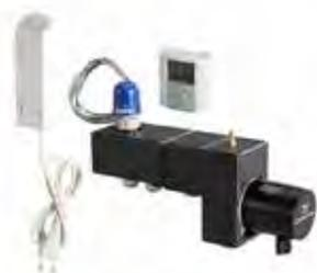
Grupo de impulsión para el control de pequeñas instalaciones de climatización por suelo y pared radiante. Puede dar servicio hasta 2 circuitos (con la misma longitud) haciendo uso de Uponor Mini Conexión para 2 circuitos. Compatible con instalación de radiadores. Cuenta con actuador de 230V y termostato inalámbrico y receptor de señal. Posibilidad de montar con orientación a derecha e izquierda. Para instalaciones con una potencia calorífica de 1-3 kW
