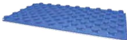
Panel certificado con [N] de AENOR. Con propiedades de aislamiento térmico y acústico frente a ruido por impacto. Fabricado con poliestireno expandido (EPS) y recubrimiento plastificado. Válido para tubo desde diámetro 16 hasta 20 mm. Permite un paso múltiplo de 75mm entre los tubos. Unión de paneles mediante doble machihembrado. Cumplimiento de la normativa UNE-EN-1264. Superficie útil 1 m<sup>2</sup>.
