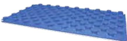
Panel de tetones fabricado con poliestireno expandido (EPS) y recubrimiento plastificado. Cumple con la normativa UNE-EN 1264. Válido para tubería desde 16 mm hasta 20 mm. El recubrimiento plastificado, fabricado en PE, permite la unión entre paneles mediante doble machihembrado y un paso de tubería de 75 mm.
