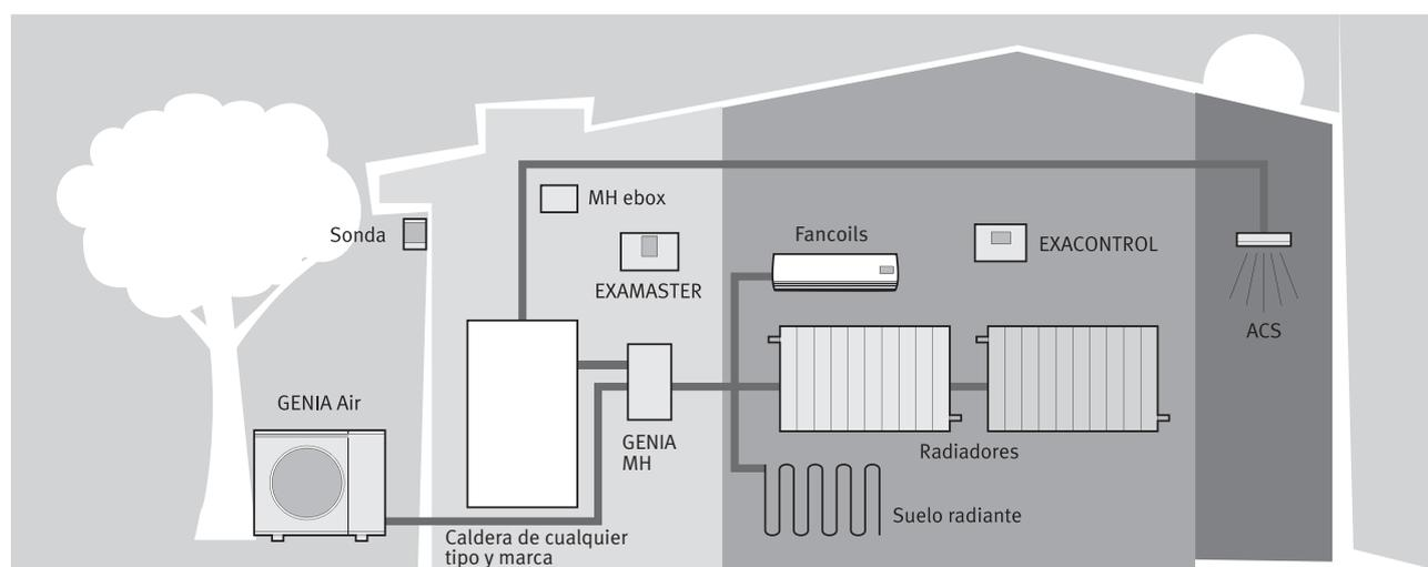
Instalación con calefacción y suelo radiante-refrescante
