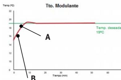
(A) Temp. impulsión caldera recalculada en función de la desviación entre la temp. real en casa y la deseada. Ej. 50 °C
