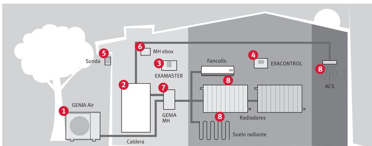
1. **Genia Air.** Generador principal. Ubicado en el circuito primario
