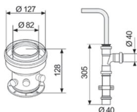
Boquilla cambio a  $\varnothing 80/125$ mm con toma de análisis y sifón de recogida de condensados
