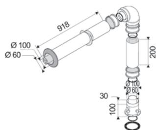
Kit salida realizada  $\varnothing 60/100$ mm (boquilla con toma de análisis + prolongador 0,2 m + codo  $90^\circ$  + terminal horizontal 0,9m)
