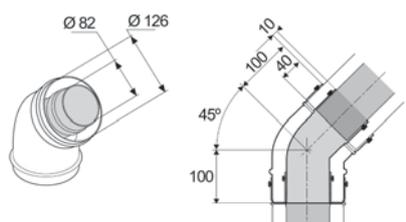
Codo  $45^\circ \varnothing 80/125$ mm
