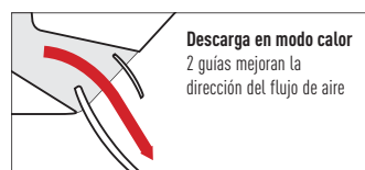
Descarga de aire idónea para modo calor
