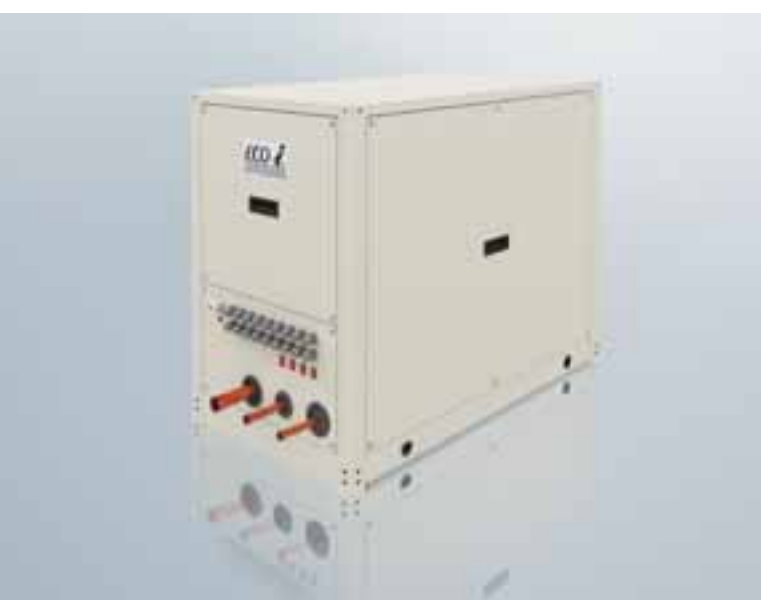
Panasonic ofrece una solución de ingeniería que permite una instalación rápida y simple. La unidad contiene 5 válvulas de bola actuadas, un recipiente de almacenamiento de 30 L y PLC, todo en el interior de un contenedor con IP54. Los terminales en la parte frontal de la unidad permiten una conexión sencilla al terminal de alarma, transductores de alta/baja presión y sensor(es) de la temperatura de descarga de las unidades interiores.
