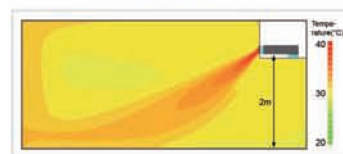
Impulsión de aire con Auto Louver.
