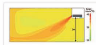
Impulsión de aire con Auto Louver.
