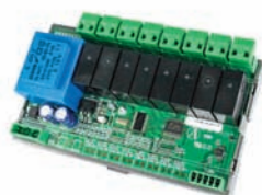
MÓDULO DE CONTROL DE ELEMENTOS RADIANTES
