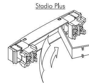
Colocación de las etiquetas de pulsadores y ajustes del nivel de audio.
