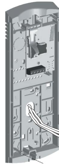
Pasar los cables de la instalación por el orificio dispuesto a tal efecto, y conectarlos a la regleta según los esquemas de instalación. Cerrar el teléfono tal y como muestra el dibujo. Una vez cerrado, conectar el auricular mediante el cordón telefónico y colocarlo en la posición de colgado.
