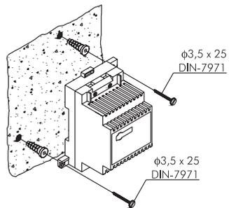
Instale el transformador en un lugar protegido. Recuerde que la normativa vigente obliga a proteger el transformador con un interruptor magnetotérmico.
