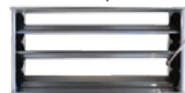
Rejilla de lama lineal fija orientada 15° con segunda deflexión vertical y regulación
