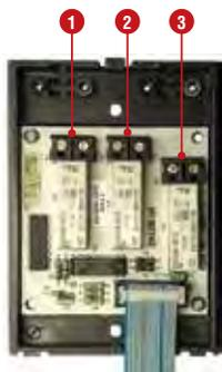
El módulo de alarma AM3-2 está provisto de 3 relés para realizar un control a distancia de: 1) quemador bloqueado, 2) quemador en funcionamiento y 3) funcionamiento en modo sanitario. Los mismos que son comandados por la MCBA. Los contactos de los relés son libres de potencial, y admiten una intensidad máxima de 1 A - 250 V.
