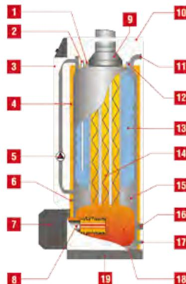
1. Termostato limitado a 95°C / termómetro / Termostato de seguridad 103°C.
